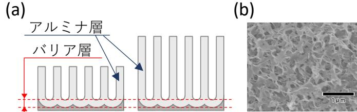
(a) 陽極酸化でアルミニウム層を厚く形成しても、赤点線の「バリア層」の厚さは  $1\mu\text{m}$  以下でほぼ一定。薄いバリア層が腐食の起点になるため、一般的な用途では、孔を埋める「封孔処理」を行う。
