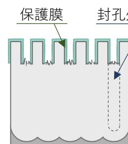
◀ 原子層堆積法（ALD）を用いて、表面微細構造に内緑のような「保護膜」を形成することで、その後に封孔処理をしても微細構造をキープできる。
