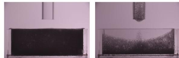
上図は、本発明の装置を使って脱泡を行った様子です。元の状態(左)と比べて、装置を稼働した後(右)では管のある中央部分の泡の量が減っていることが分かります。
